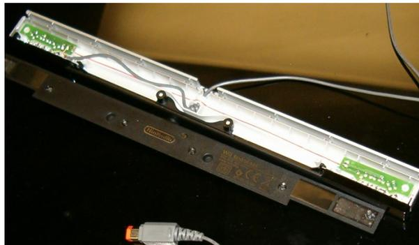
L'INTÉRIEUR DE LA *SENSOR BAR*, AVEC SUR LA GAUCHE ET LA DROITE LES ENSEMBLES DE *LEDS* INFRAROUGES (SOURCE : [WII.ORG](http://wii.org))
